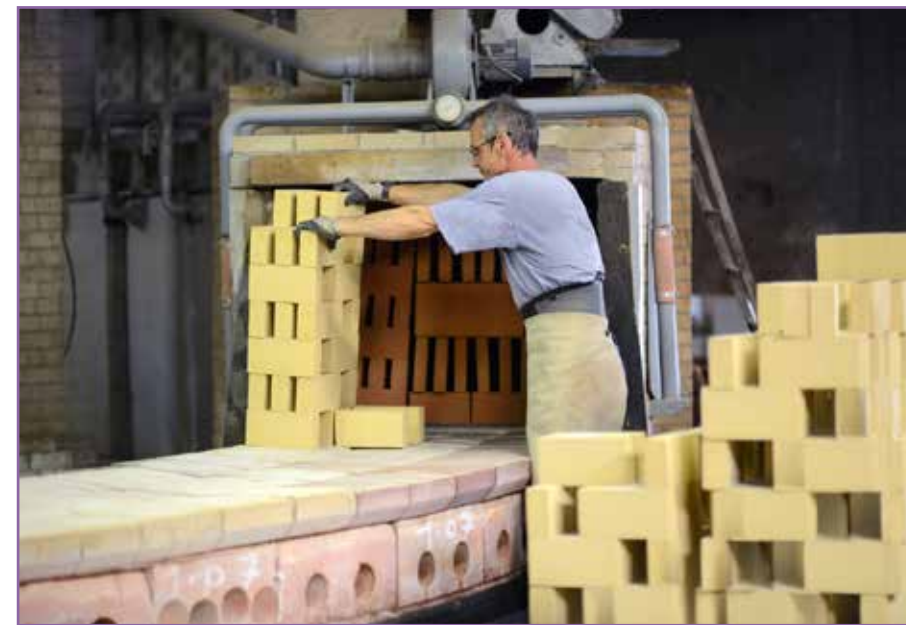
Entreprise Fayol, entrée des briques dans le four pour 24 heures de cuisson.
